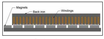
Fig. 5: Ironcore linear motor
